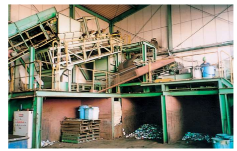
自動選別機 磁力でスチール缶とアルミ缶を分けています
